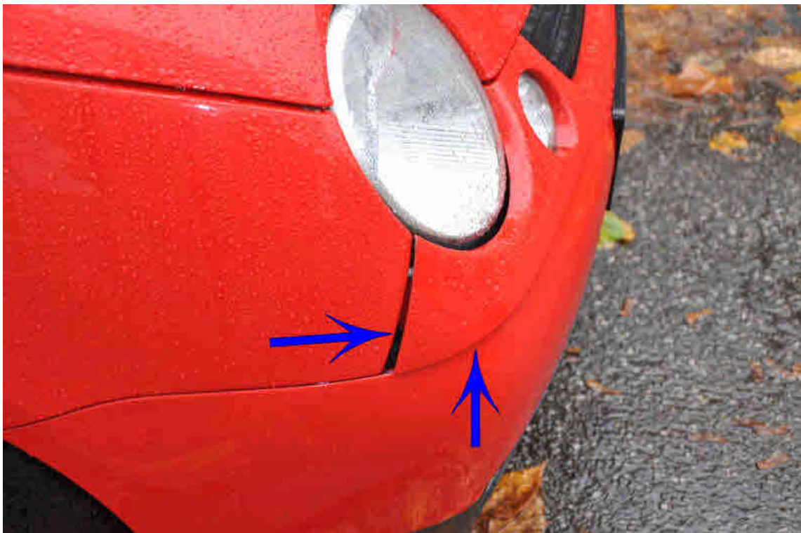
Bild 04: ...durchgeschoben > Halterung Frontblende gebrochen
