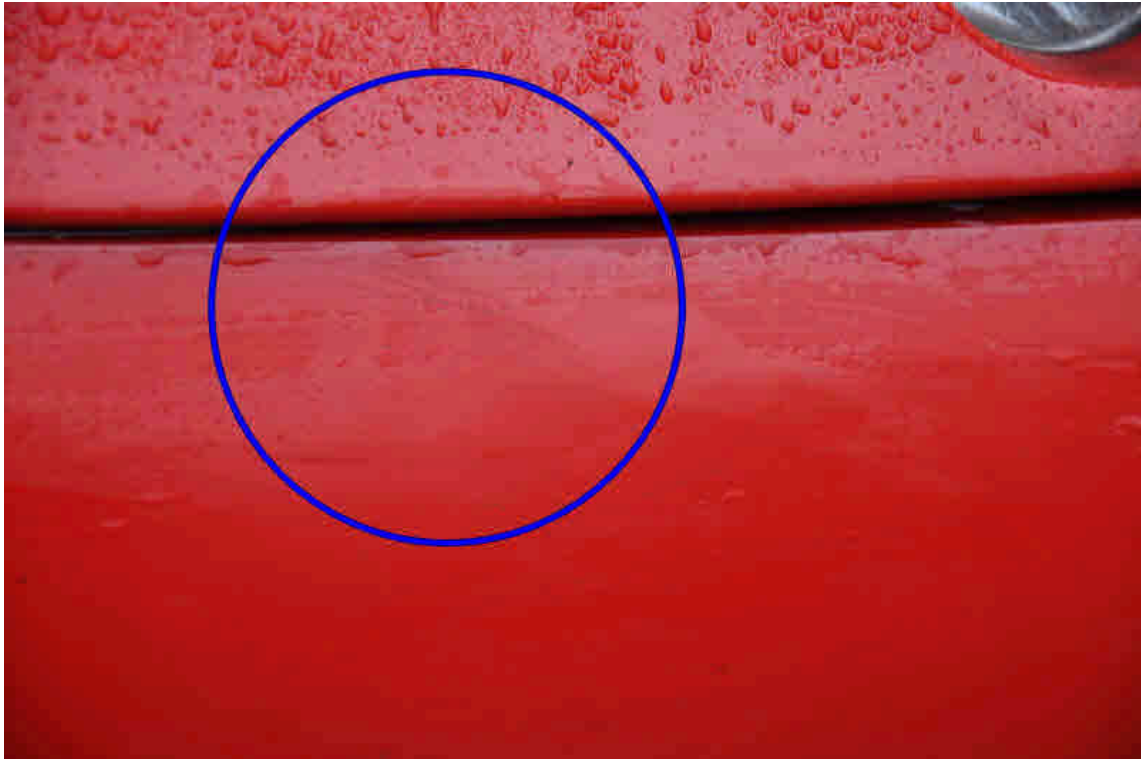
Bild 03: Stoßfängerverkleidung v.r. angeschürft und beaufschlagt
